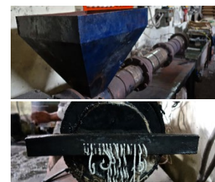
Extrusora de plástico en una instalación de reciclaje.
