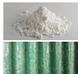
Arriba: Mineral de relleno ( \text{CaCO}_3 ) Abajo: Fibra de vidrio
