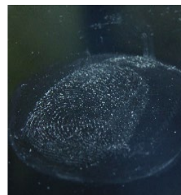
Depósito blanco causado por la reacción de acetona con PC
